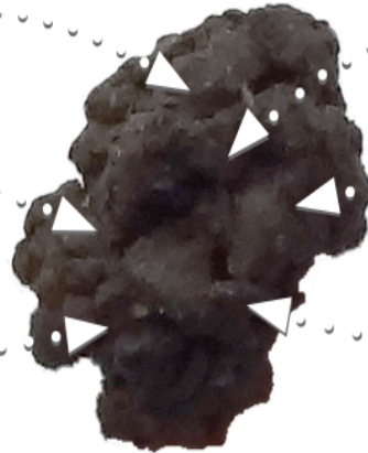
Типичная гранула размером 2 мм показана при 25-кратном увеличении
