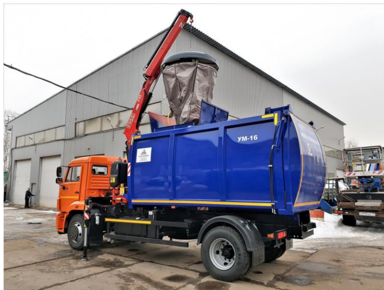
Мусоровоз с краном – манипулятором для опорожнения заглубленных контейнеров
