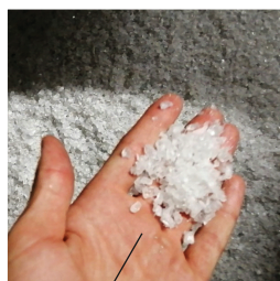
Так выглядят дробленые полимеры (ПВД, ПНД) и гранулированное вторсырье для дальнейшего производства
