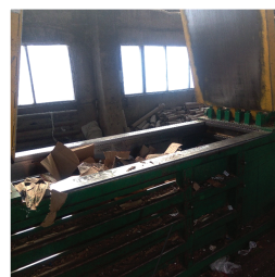
Гидравлический пресс и формируе- мый в нем тюк картона
