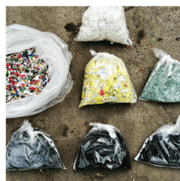
Так выглядят дробленые полимеры (ПВД, ПНД) и гранулированное вторсырье для дальнейшего производства
