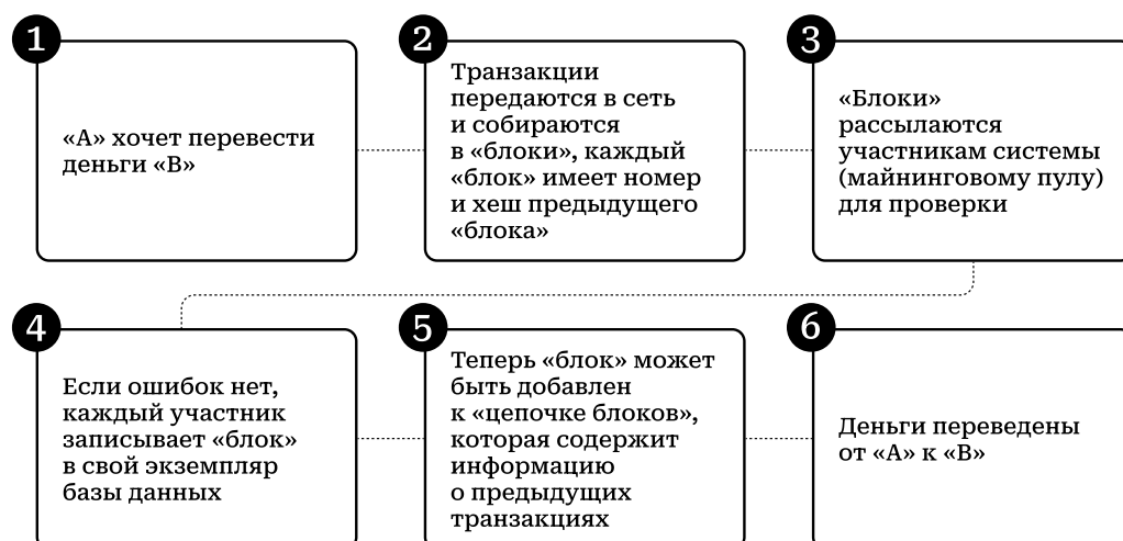
Рисунок 14. Упрощенная схема осуществления транзакций с помощью блокчейна
